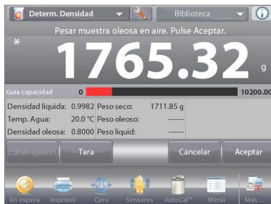
**Paso 3 de 3 – Pesar la muestra oleosa sumergida en líquido.**
