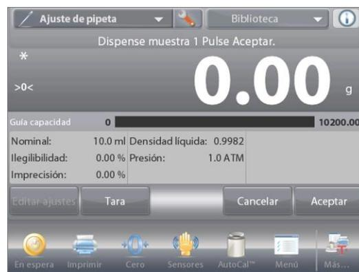
Continúe siguiendo las instrucciones en pantalla preparando muestras y pulsando **Aceptar** para guardar el peso de cada muestra (líquido).
