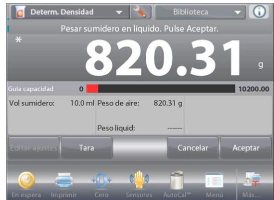
Una vez que se han determinado los pesos necesarios, la densidad de la muestra líquida aparece en  $\text{g/cm}^3$  (junto con el peso en aire y peso en agua) en la pantalla de la aplicación.
