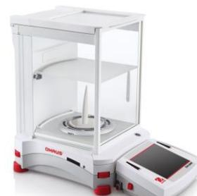
Introduzca los extremos en forma de gancho de la puerta superior en las clavijas acanaladas. Presione suavemente hasta colocarlos. Compruebe que sea un movimiento suave. Cierre la puerta.
