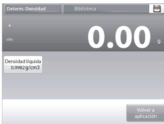
Mida la densidad líquida real del ajuste de densidad e introdúzcala.
