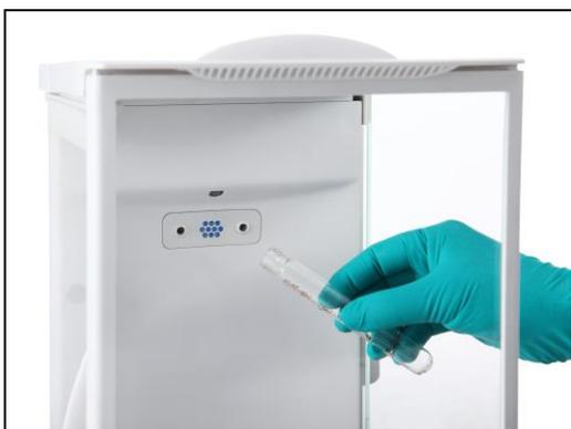
El ionizador genera iones bipolares continuamente mediante una corona de descarga de CC separadamente de los electrodos de descarga positiva y negativa y dirige el aire ionizado hacia el cuerpo cargado para eliminar la electricidad estática. Los iones generados tienen un buen equilibrio en polaridad y pueden eliminar la electricidad estática independientemente de la polaridad del cuerpo cargado.
