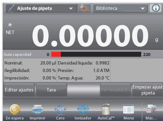
Toque **Empezar ajuste de pipeta**. Siga las instrucciones en pantalla para **Poner contenedor encima del plato. Luego Pulse Tara.**
