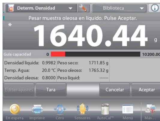
Una vez que se han determinado los pesos necesarios, la densidad de la muestra aparece en  $\text{g/cm}^3$  (junto con el peso en aire, no oleosa y oleosa y peso en agua) en la pantalla de la aplicación.
